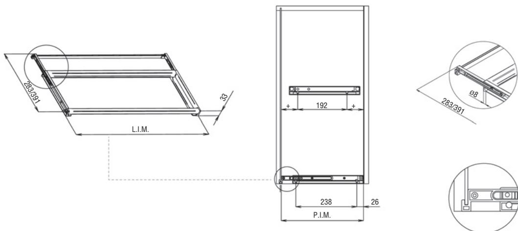
Рамка алюминиевая с телескопическим профилем сушики Variant для крепления задней стенки шкафа
